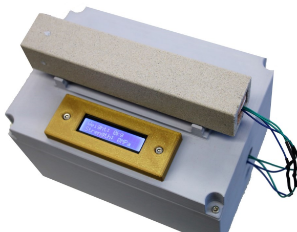
Bild 2: Biegeversuch eines mit DMS versehenen Sandkerns, Foto: utg
