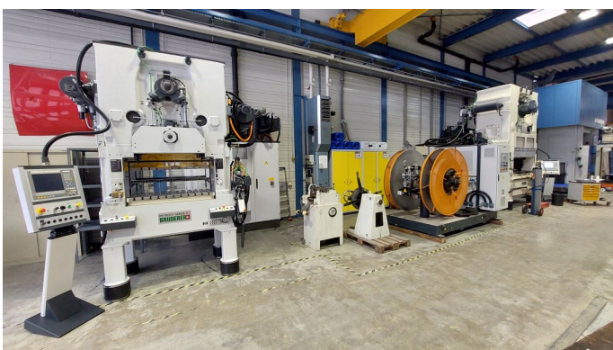
Bruderer Stanzautomaten BSTA 50 - 110 (links) und BSTA 1600 - 181 (rechts), Foto: utg
