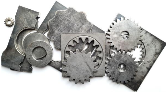
Abbildung 1: Feingeschnittene Bauteile aus dem Schwerpunktprogramm SPP2013
