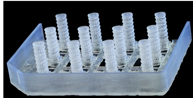
Mittels Stereolithografie erstellter bionischer Prototyp
