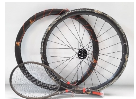
Sensorik in Sportgeräten: Fahrradfelge und Tennisschläger aus CFK mit DMS und Piezokeramiken
